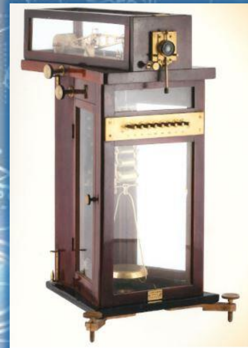
Весы одноплечие аналитические конструкции И.Д. Менделеева
